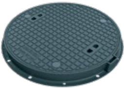
SA DN 600 , tagwasserdicht und rückstausicher 1 bar Deckel GE, Rahmen GE
