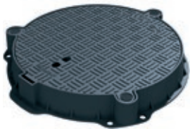
EURO TOP DICHT DN 600 , tagwasserdicht und rückstausicher 0,5 bar Deckel GE, Rahmen GE
